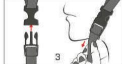
W CELU ZAPIĘCIA KASKU PROSZE WCISNĄĆ JEDNA POŁOWĘ SPRZĄCZKI W DRUGĄ, POCIĄGNĄĆ PASEK, ABY MIEĆ PEVNOSC, ŹE SPRZĄCZKA JEST PRAWIDŁOWO POŁĄCZONA, A SYSTEM ROZPOROWY ZAPIĘCIA ZABŁOKOWANY. PATRZ RYS. 3
