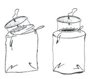
1. Gelben Deckel in den Fangbeutel einlegen, Schnurzug bis zu den Stegen zuziehen und verknoten.
